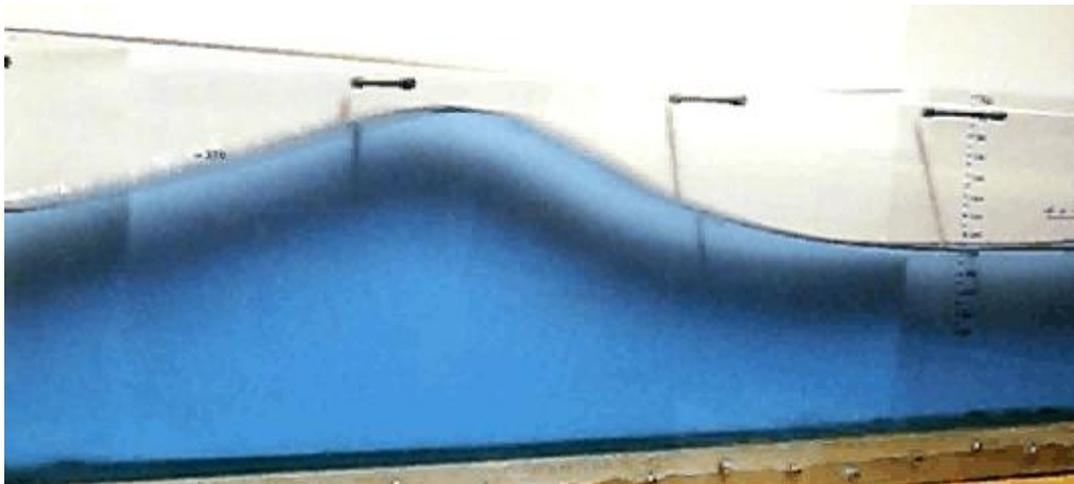
**WAVE-MASTER GENERATING 1/10<sup>TH</sup> SCALE LAMINAR WAVES**
